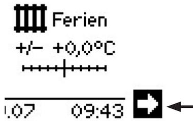
Navigationspfeil ansteuern und durch Drücken des „Dreh-Druck-Knopfs“ auswählen.
