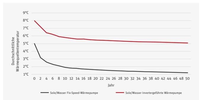
Im Ergebnis der Simulation über einen Zeitraum von 50 Jahren liegen die Soletemperaturen bei der invertergeführten Wärmepumpe im Mittel um etwa 3–4 K höher als bei der Fix-Speed-Wärmepumpe. Das Ergebnis belegt nach dieser Berechnung recht eindeutig, dass sich der invertergeführte Betrieb sehr wärmequellenschonend auswirkt.
