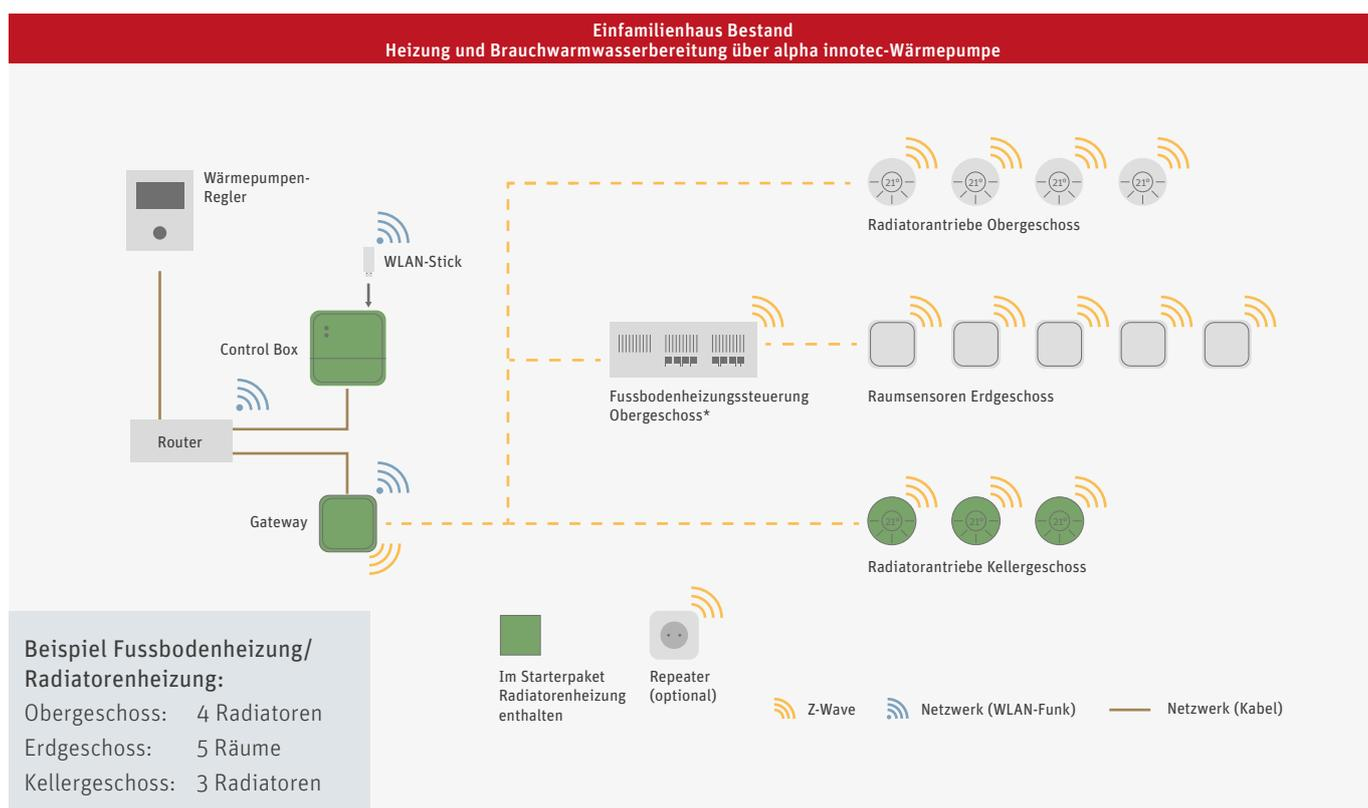
\* Die Stellantriebe (230V) für die Ventile des Bodenheizungsverteilers werden bauseits geliefert.
