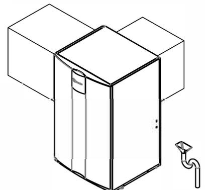
Fassadenaufstellung lang, Ausblas rechts
