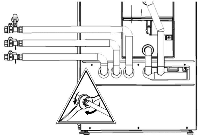
Sicherheitsventil immer am Rücklauf (oberstes Rohr) montieren!
