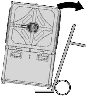
2. Das Wärmepumpenmodul mit Spanngurt am Sackkarren sichern.
