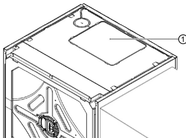
2. Nach Abnahme des Deckels (①) kann der gesamte Kondensatwannenbereich vor (②) und nach (③) dem Verdampfer eingesehen und gegebenenfalls gereinigt werden.
