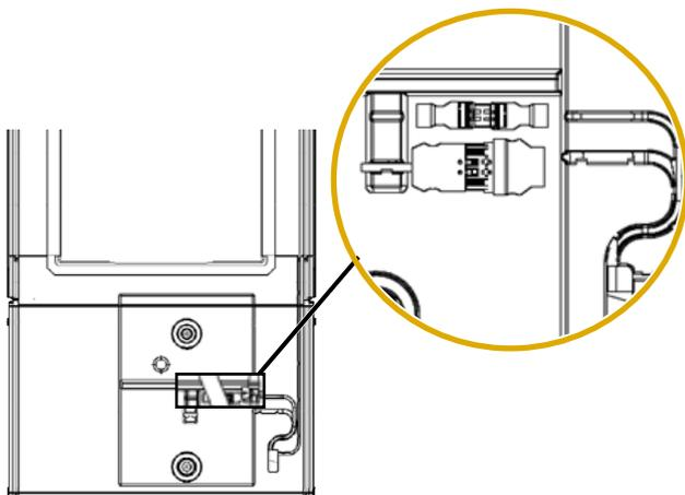
3. Abdeckung für Steckerverbindungen montieren.
