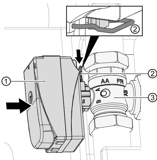
11. Sicherstellen, dass der Bügelstift korrekt eingearastet ist:
