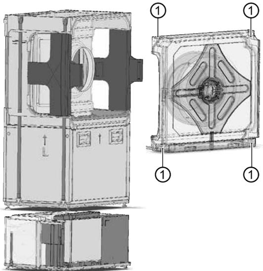
Die Stellfüße des Wärmepumpenmoduls nicht verändern, da sonst die Gehäusewände nicht mehr passen!
