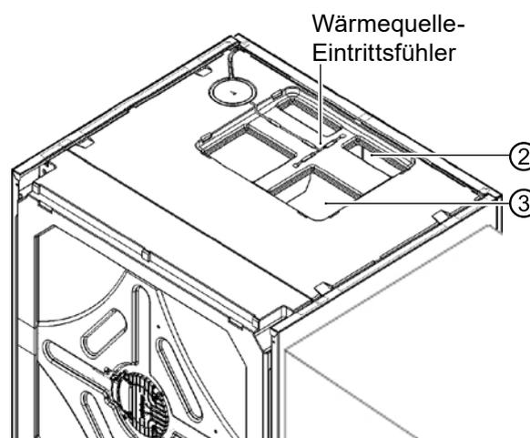
Alternativ hierzu können die seitlichen Luftkanäle, die Seitenwände sowie Lamellengitter und Blinddeckel (bei Bedarf auch das Ventilatormodul) abgenommen werden, um eine bessere Zugänglichkeit zu erlangen.
