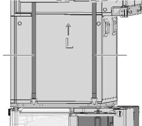
4. Spannschloß öffnen, Haken am Grundblech um 90° drehen.
