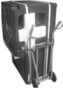
3. Wärmepumpenmodul zum Ausstellungsort transportieren.
