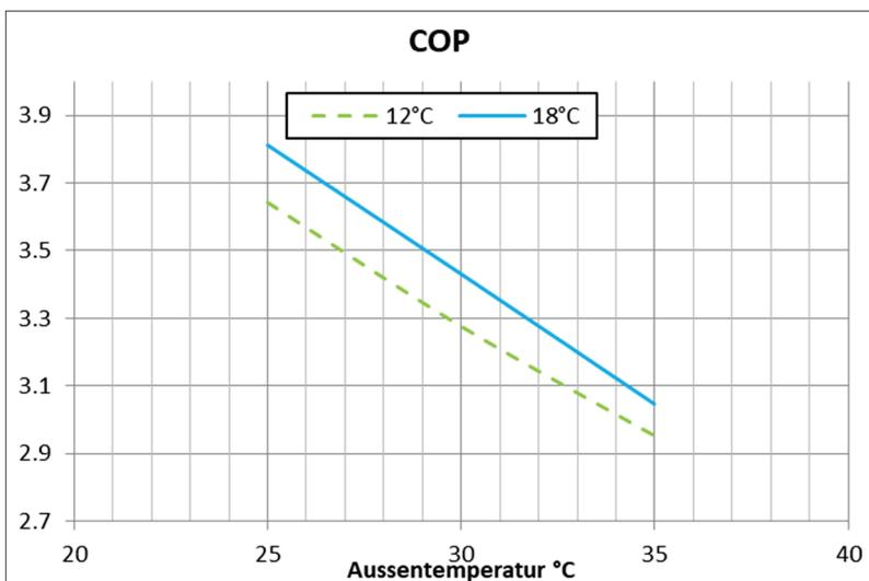
Vorlauf 12°C bei Rücklauf 17°C ( $\Delta T$  5 K) / Vorlauf 18°C bei 23°C Rücklauf ( $\Delta T$  5 K)
