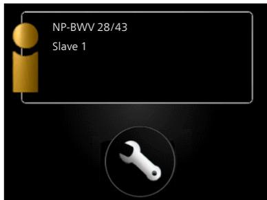
Wenn die Wärmepumpe als Slave eingestellt ist, wird ein begrenztes Hauptmenü im Display angezeigt, das den Hinweis enthält, dass die meisten Systemeinstellungen an der Master-Wärmepumpe vorzunehmen sind.
