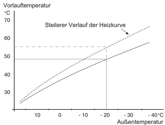
Der Verlauf der Heizkurve bestimmt, um wieviel Grad die Vorlauftemperatur erhöht bzw. gesenkt werden soll, wenn die Außentemperatur sinkt bzw. steigt. Ein steilerer Verlauf der Heizkurve bewirkt eine höhere Vorlauftemperatur im Verhältnis zur Außentemperatur.
