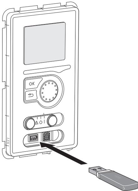
F1345 ist mit USB-Anschlüssen im Bedienfeld ausgestattet. Mit diesen USB-Anschlüssen können z.B. USB-Stick verbunden werden, um die Software zu aktualisieren, protokollierte Informationen zu speichern und Einstellungen in F1345 zu verwalten
