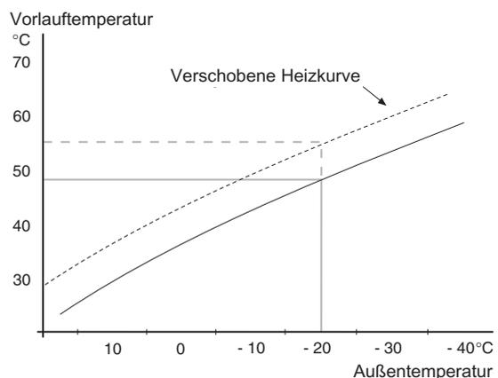
Bei einer Parallelverschiebung der Heizkurve ändert sich die Vorlauftemperatur in gleichem Maße bei allen Außentemperaturen. So steigt bei z.B. einer Parallelverschiebung der Heizkurve um +2 Schritte die Vorlauftemperatur bei allen Außentemperaturen um 5°C.
