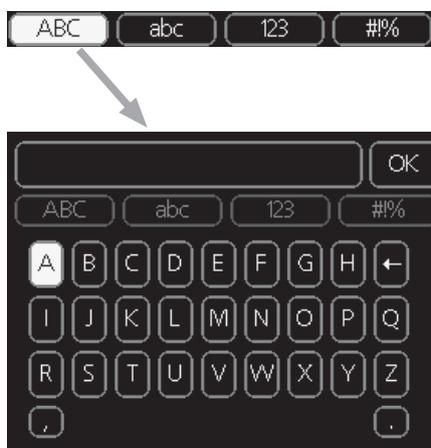
Je nach Menü stehen mehrere Zeichensätze zur Auswahl, zwischen denen per Wählrad umgeschaltet wird. Um zwischen den Zeichensätzen zu wechseln, drücken Sie die Zurück-Taste. Wenn für ein Menü nur ein Zeichensatz verfügbar ist, erscheint die Tastatur direkt.
