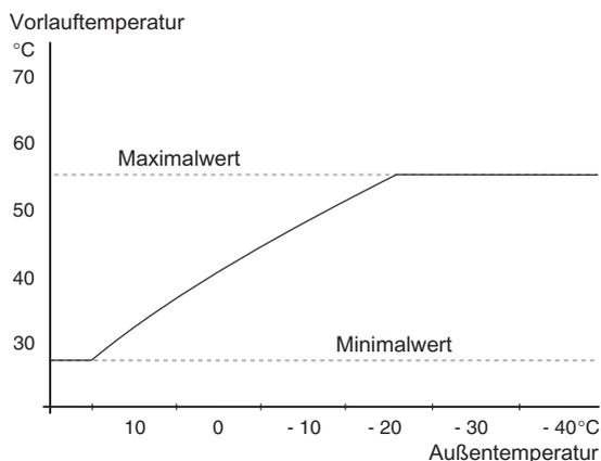
Da die Vorlauftemperatur den eingestellten Maximalwert nicht überschreiten und den eingestellten Minimalwert nicht unterschreiten kann, flacht die Heizkurve bei diesen Temperaturen ab.
