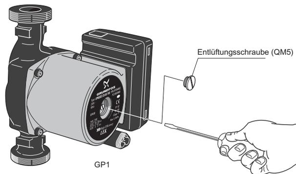
Auf der Abbildung wird ein mögliches Beispiel für eine Umwälzpumpe dargestellt.
