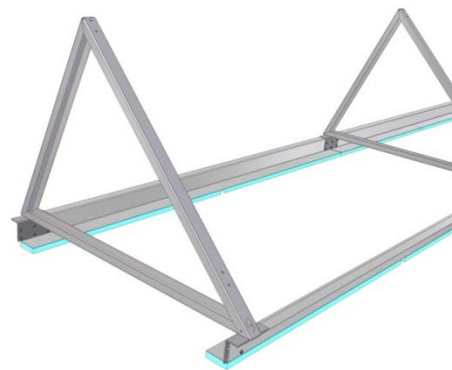
Detail Ständerbefestigung aussen (mittlere Gewindereihe verwenden)
