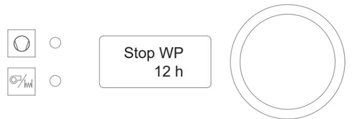
Drehen Sie den Drehknopf erneut zum Menüpunkt "Stop WP". Drücken Sie die Taste, bis der Text blinkt und stellen die Minuten der Stoptzeit ein. Drücken Sie die Taste erneut, um die Minuten zu bestätigen.
