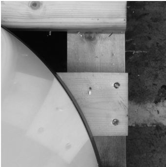
1. Zu entfernende Schrauben (Torx).
