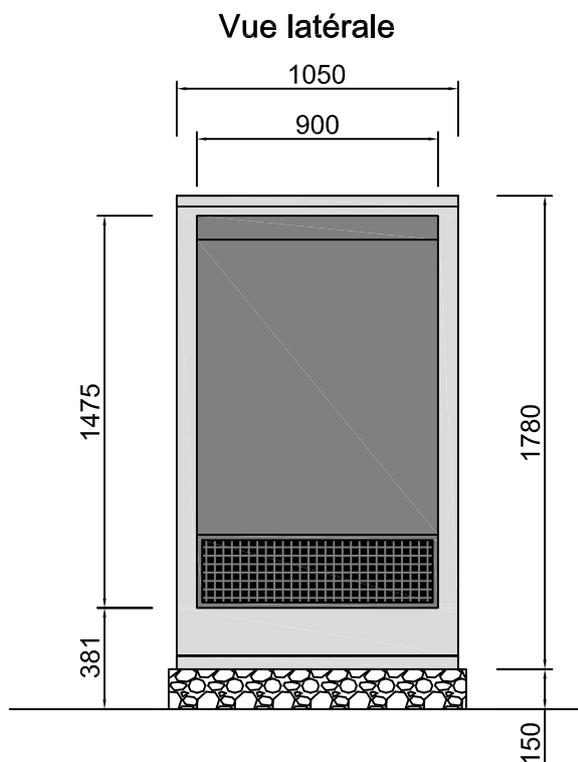
La formation d'un lac d'air froid doit être évitée. L'air soufflé doit pouvoir s'écouler librement et toute recirculation d'air doit être évitée. La distance latérale par rapport aux murs du bâtiment doit être d'au moins 0.8 m.
