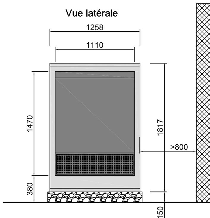
La formation d'un lac d'air froid doit être évitée. L'air soufflé doit pouvoir s'écouler librement et toute recirculation d'air doit être évitée. La distance latérale par rapport aux murs du bâtiment doit être d'au moins 0.8 m.
