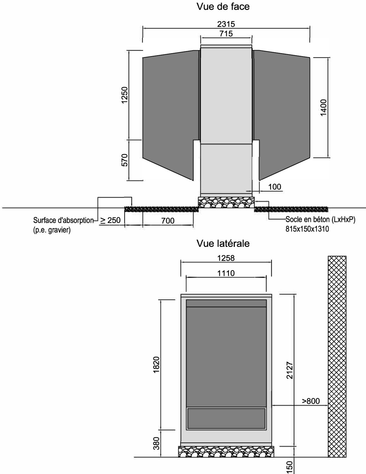
La formation d'un lac d'air froid doit être évitée. L'air soufflé doit pouvoir s'écouler librement et toute recirculation d'air doit être évitée. La distance latérale par rapport aux murs du bâtiment doit être d'au moins 0.8 m.
