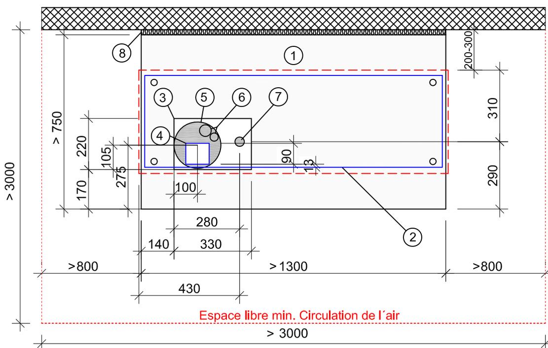
**Important:** La pompe à chaleur doit être installée dans un endroit abrité. La formation de lacs d'air froid doit être évitée. L'air de sortie doit pouvoir s'écouler sans entrave.
