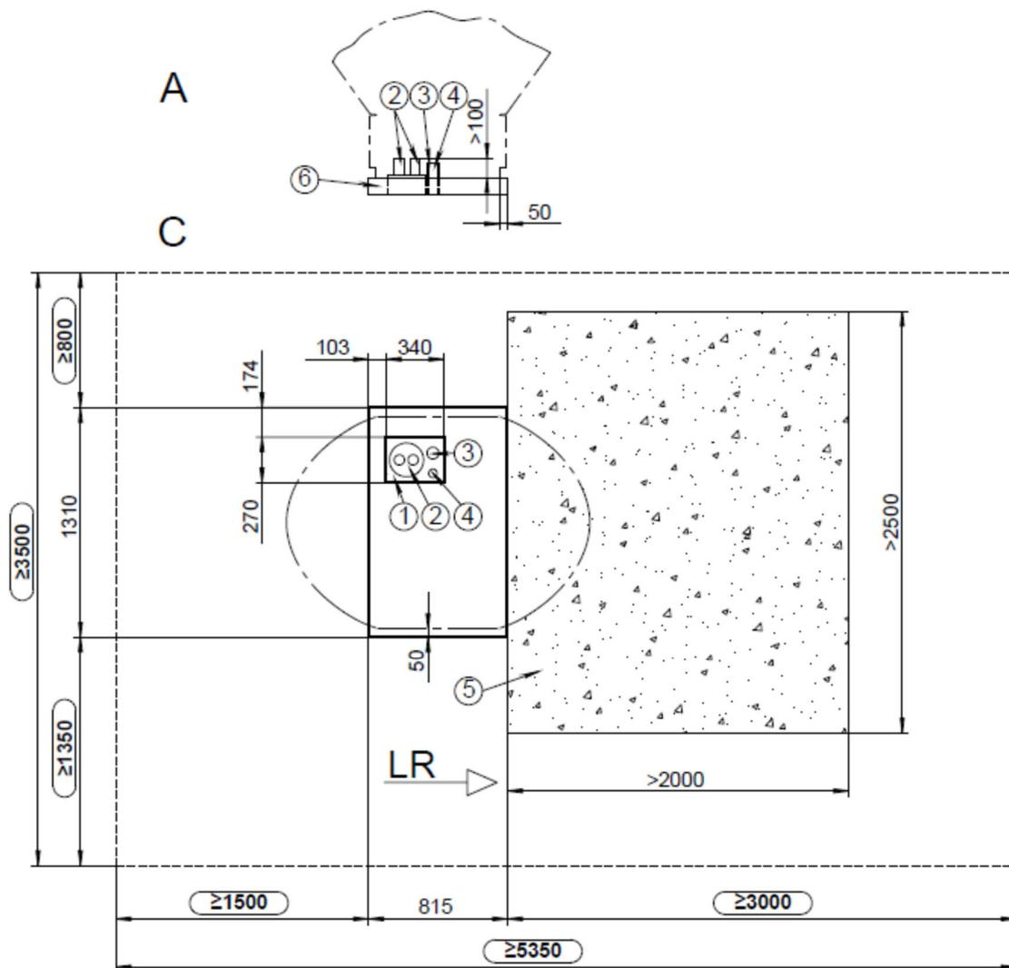
La formation d'un lac d'air froid doit être évitée. L'air souffle doit pouvoir s'écouler librement et toute recirculation d'air doit être évitée. La distance latérale par rapport aux murs du bâtiment doit être d'au moins 0.8 m.
