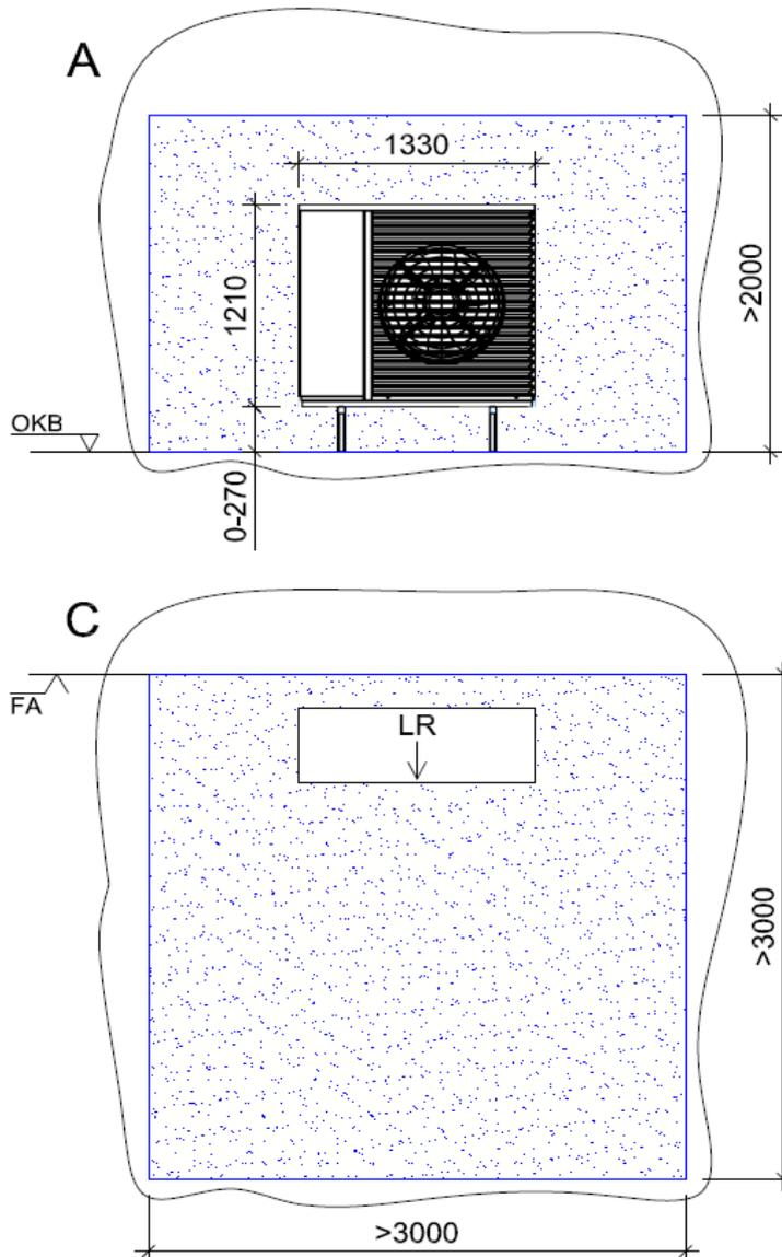
Important: La pompe a chaleur doit etre installée dans un endroit abrite. La formation de lacs d'air froid doit etre evitee. L'air de sortie doit pouvoir s'écouler sans entrave.
