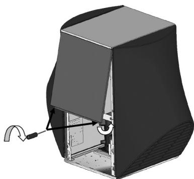
Les capots sont maintenant montés. Vous pouvez procéder aux travaux de montage et d'installation sur l'appareil et remettre ensuite en place les façades inférieures. (voir « Travaux de raccordement électrique »).
