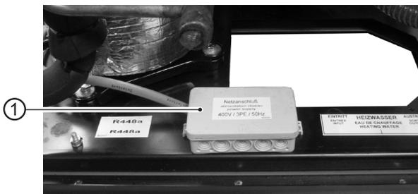
1 Prise de connexion: Raccordement au réseau de la pompe à chaleur
