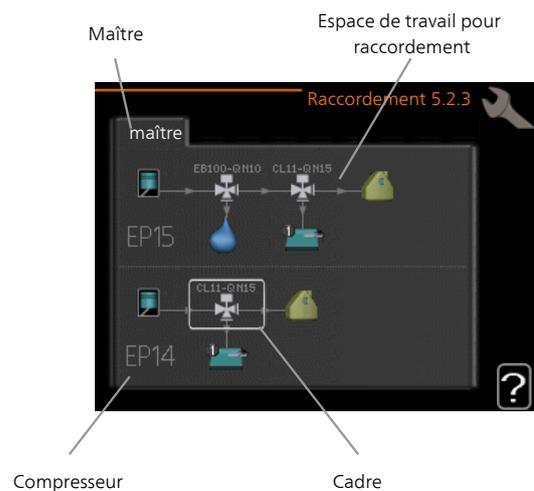
**Compresseur :** sélectionnez si votre compresseur (EP14 ou EP15) est bloqué (paramètre d'usine), commandé de l'extérieur par une entrée progressive ou standard (raccordée au chauffage de la piscine, au chauffage de l'eau chaude et au chauffage du bâtiment, par exemple).
