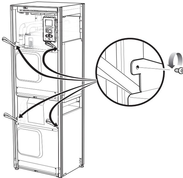
5. Retirez les attaches (quatre pour chaque module compresseur) et séparez doucement les tuyaux.
