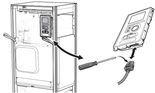
7. Retirez les deux vis retenant l'écran dans le cadre (cette procédure doit uniquement être effectuée si vous êtes sur le point de retirer le module compresseur supérieur).
