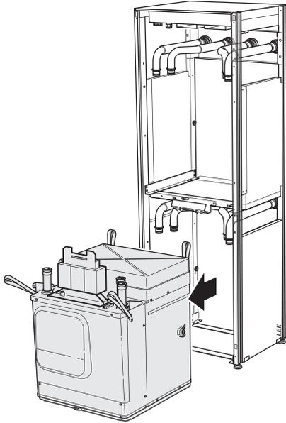
Si la pompe à chaleur n'est pas fixée en position, le module compresseur supérieur doit toujours être retiré avant le module inférieur.
