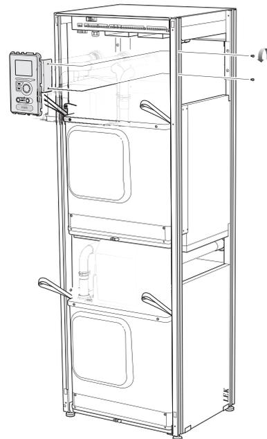
8. Retirez doucement le module compresseur supérieur (EP15) à l'aide des boucles de levage du module. Utilisez une surface en relief à hauteur ajustable pour cette procédure.
