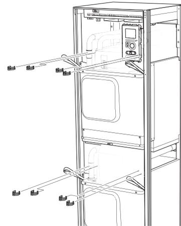
6. Retirez le connecteur sous l'écran (cette procédure doit uniquement être effectuée si vous êtes sur le point de retirer le module compresseur supérieur).
