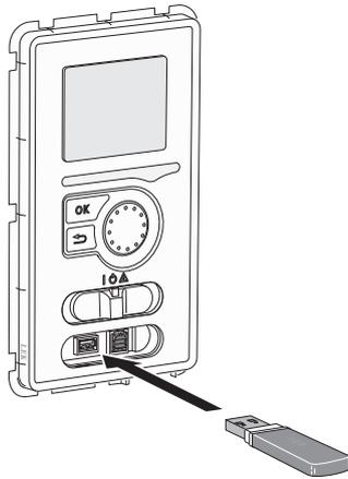
L'afficheur est équipé d'un port USB qui permet de mettre à jour le logiciel, d'enregistrer les informations consignées et de gérer les paramètres dans F1355.
