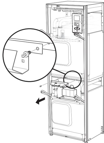
10. Retirez doucement le module compresseur inférieur (EP14) à l'aide des boucles de levage du module.
