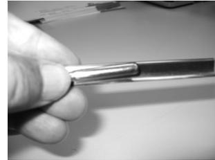
1. Positionner le capteur à l'extérieur du ressort de capteur.
