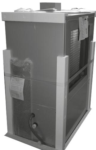
Apparecchio con compressore pienamente ermetico, tutti i componenti di sicurezza importanti per il controllo del circuito di raffreddamento, regolatore della pompa di calore e riscaldamento integrato, sensori montati nell'apparecchio per rilevamento della temperatura di gas caldo, temperatura di mandata dell'acqua di riscaldamento e temperatura di ritorno e flessibile per lo scarico della condensa (collegato sul lato pompa di calore)
