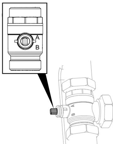
4. Sciacquare il circuito di carico dell'acqua calda sanitaria per ca. 1 minuto.
