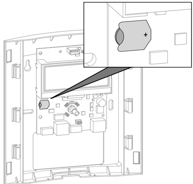
2. Smaltire la batteria tampone nel rispetto delle disposizioni locali.
