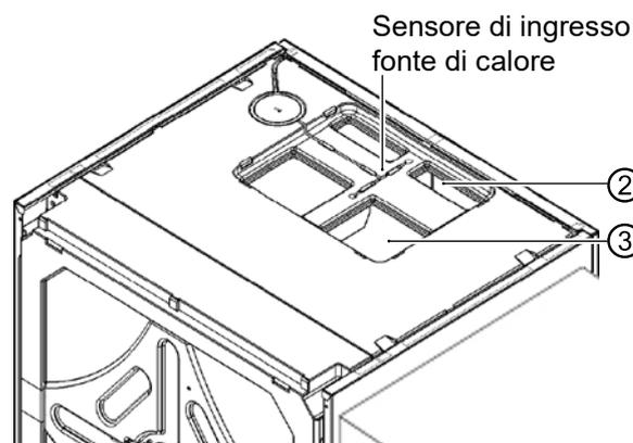
In alternativa si possono rimuovere i canali dell'aria laterali, le pareti laterali, le griglie ad alette ed i coperchi cieci (se necessario anche il modulo ventola) per avere migliore accessibilità.
