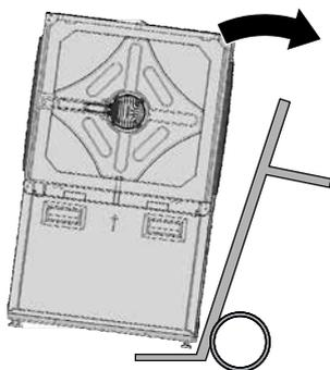
2. Fissare il modulo pompa di calore sul carrello per sacchi con la cinghia di bloccaggio.
