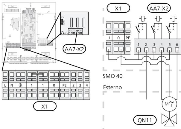
Se occorre utilizzare i relè per il controllo della tensione, realizzare un ponte per l'alimentazione dalla morsettiera X1:1 a X2:1, X2:3 e X2:5 sulla scheda relè aggiuntiva (AA7).
