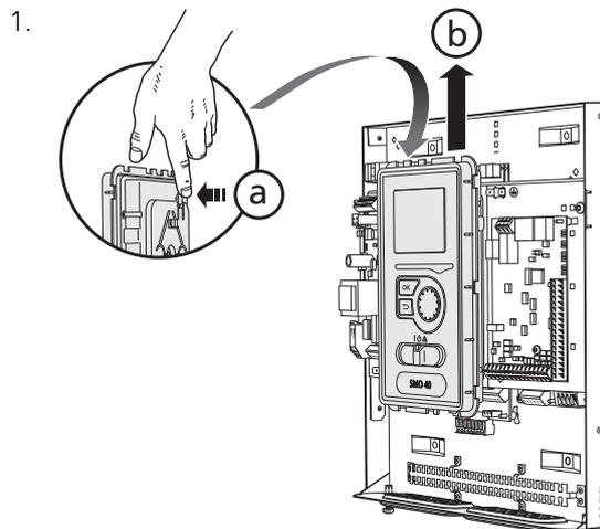
1. Premere verso di sé il fermo sul lato posteriore superiore del display (a) e spostare il display in alto (b) in modo che i fermi si sgancino dal pannello.
