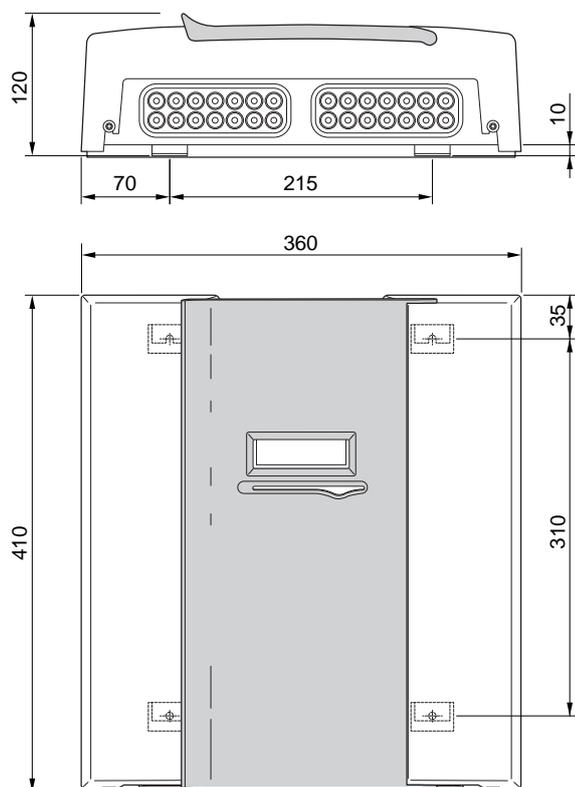
Utilizzare tutti i punti di montaggio e installare SMO 40 in posizione verticale contro la parete, senza che alcun elemento del modulo di controllo sporga oltre il bordo della parete.
