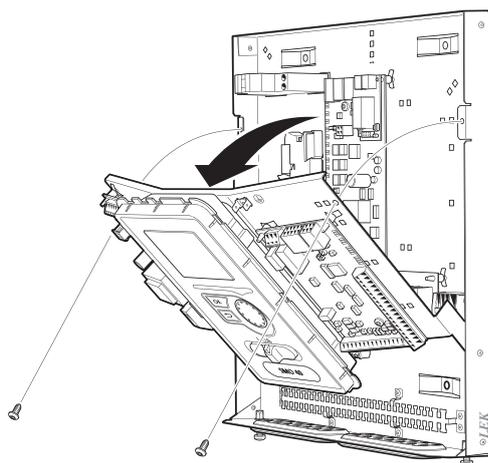
Potrebbe essere necessario spostare il display per un accesso più facile quando si effettuano i collegamenti elettrici. È possibile effettuarlo facilmente in base ai passaggi seguenti.
