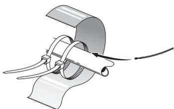
I sensori di temperatura vengono montati con pasta termoconduttrice, fascette fermacavi (la prima fascetta viene fissata al tubo al centro del sensore e l'altra viene montata circa 5 cm al di sotto del sensore) e nastro in alluminio. Successivamente isolare con il nastro isolante in dotazione.
