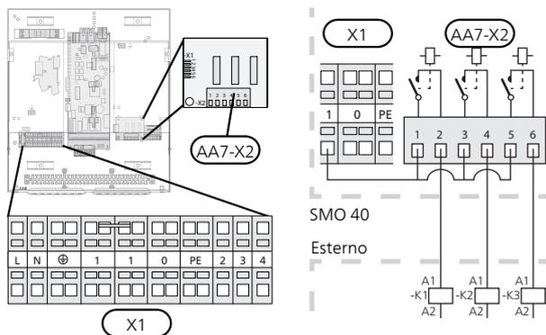
Se occorre utilizzare i relè per il controllo della tensione, realizzare un ponte per l'alimentazione dalla morsetteria X1:1 a X2:1, X2:3 e X2:5 sulla scheda relè aggiuntiva (AA7). Collegare alla morsetteria X1:0 il neutro proveniente dal riscaldamento supplementare esterno.
