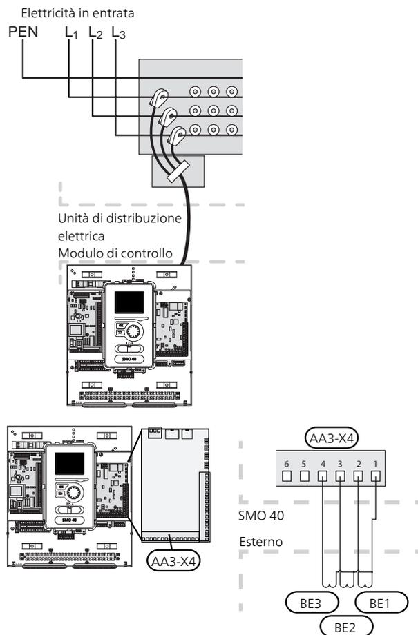
Se la pompa di calore installata è controllata in frequenza, sarà limitata quando vengono disattivati tutti gli stadi di potenza.
