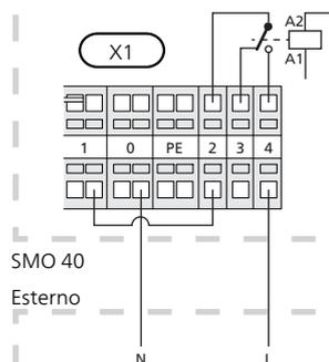
Se occorre utilizzare il relè per il controllo della tensione, realizzare un ponte per l'alimentazione fra le morsettiere da X1:1 a X1:2, quindi collegare il neutro e il segnale di controllo in tensione provenienti dal riscaldamento supplementare esterno a X1:0 (N) e X1:4 (L).
