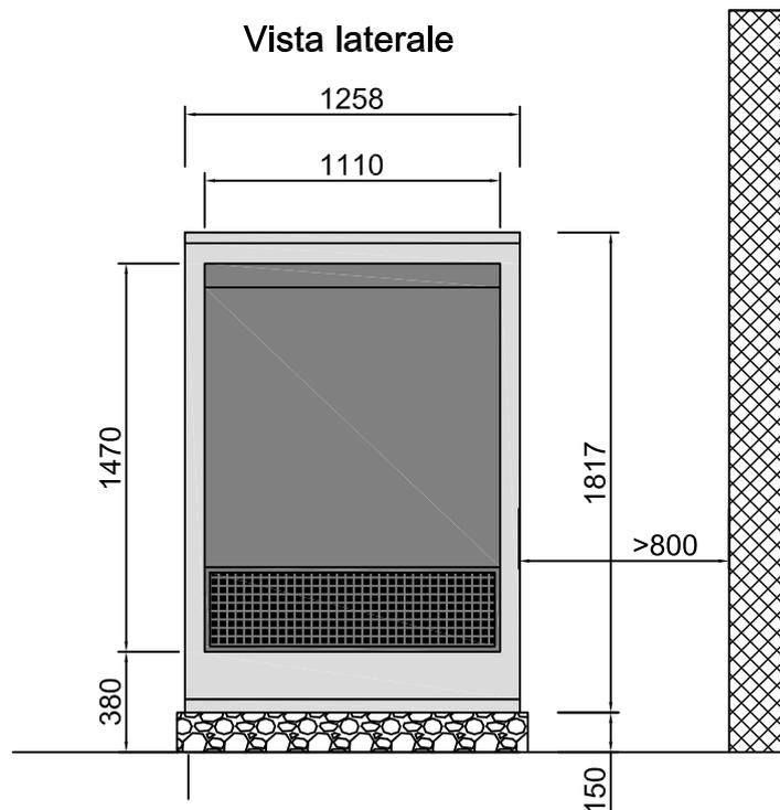
Occorre evitare la formazione di sacche d'aria fredda. L'aria di espulsione deve poter defluire senza ostacoli per evitare il ricircolo. La distanza dalle pareti laterali dell'edificio deve essere di almeno 0.8 m.
