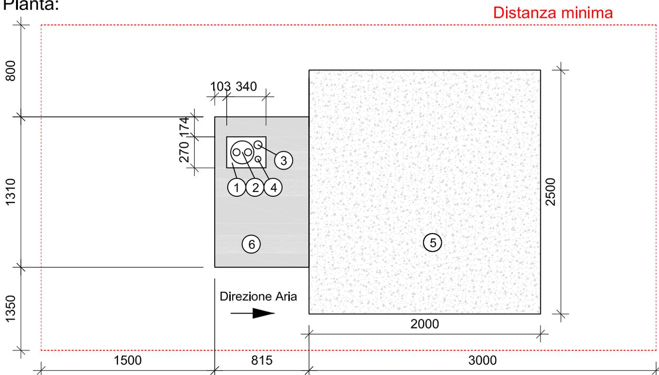
Occorre evitare la formazione di sacche d'aria fredda. L'aria di espulsione deve poter defluire senza ostacoli per evitare il ricircolo. La distanza dalle pareti laterali dell'edificio deve essere di almeno 0.8 m.
