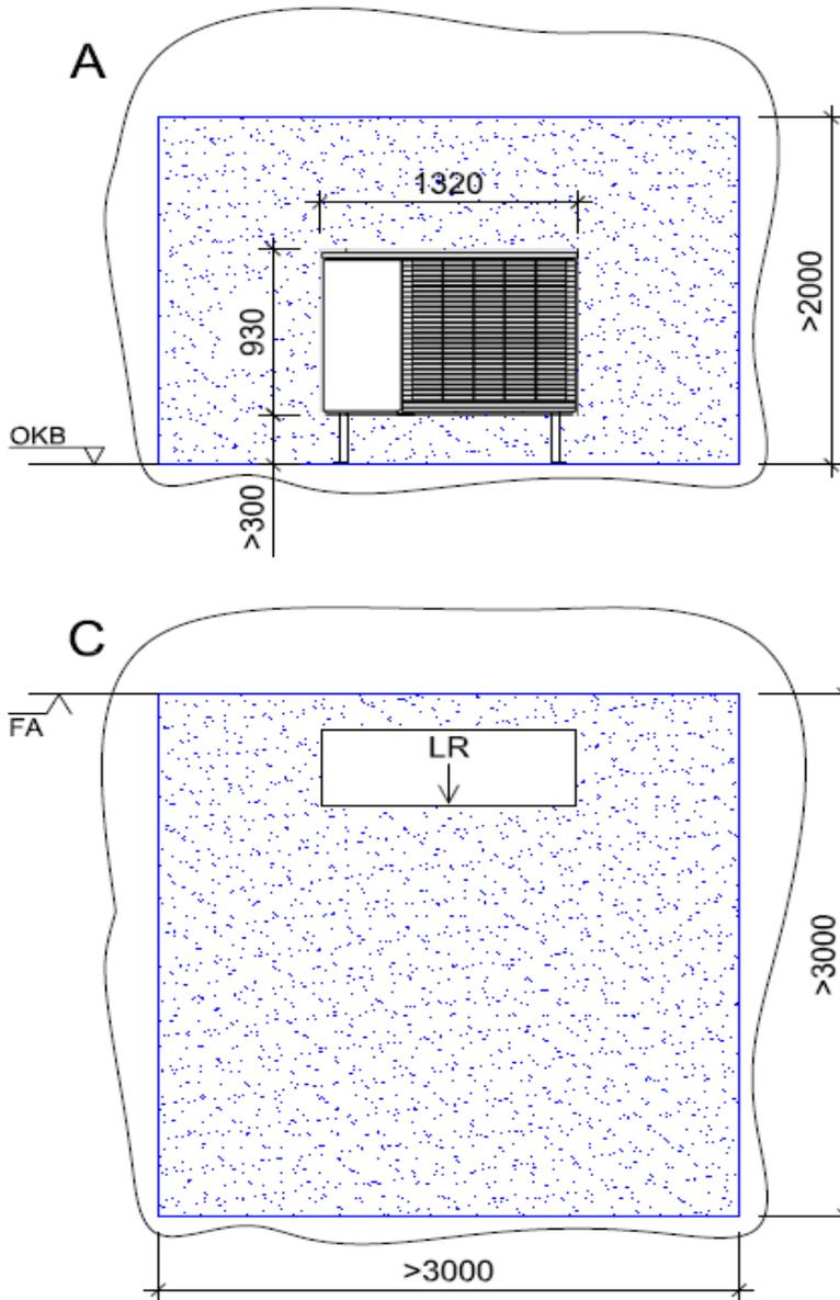
Importante: La pompa di calore deve essere installata in un luogo riparato. Si deve evitare la formazione di laghi di aria fredda. L'aria in uscita deve poter scorrere via senza ostacoli.
