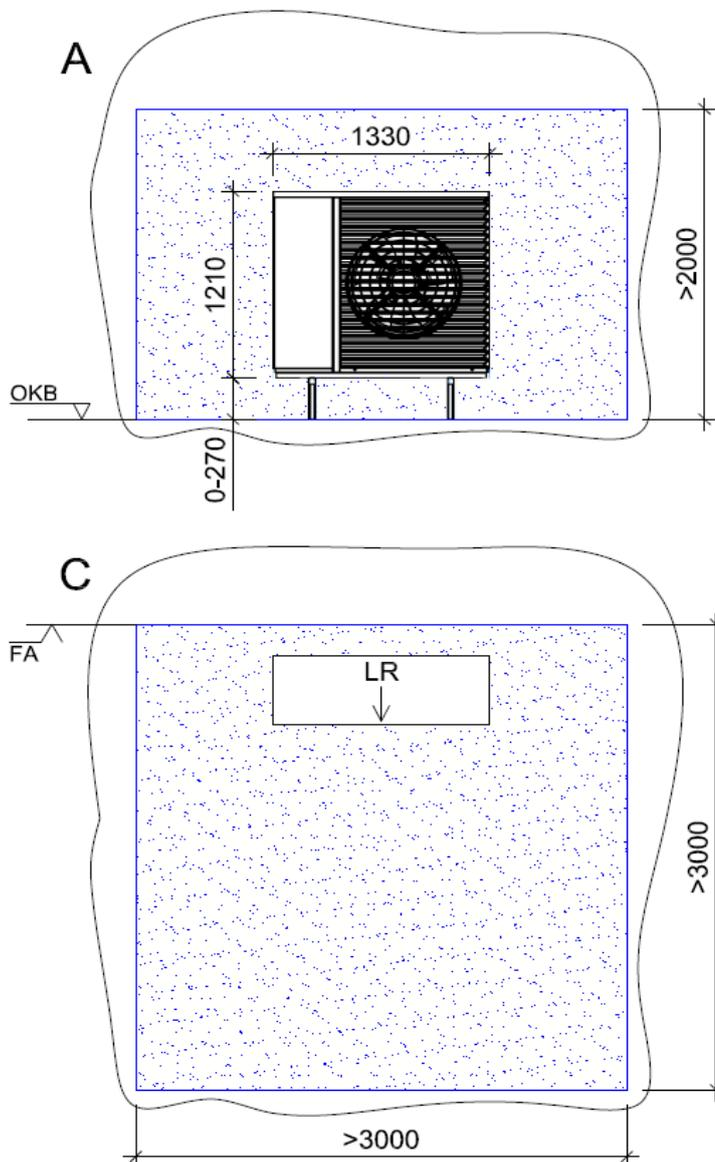
Importante: La pompa di calore deve essere installata in un luogo riparato. Si deve evitare la formazione di laghi di aria fredda. L'aria in uscita deve poter scorrere via senza ostacoli.
