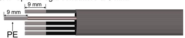
6.5. Inserire i conduttori isolati nei pin del connettore a 5 conduttori (④).
