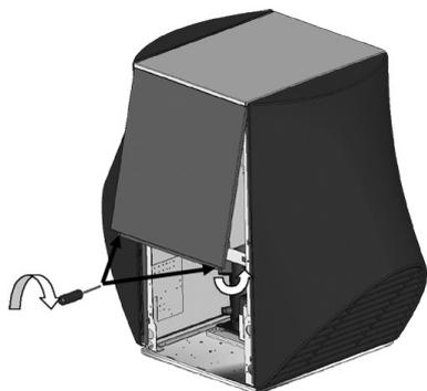
A questo punto, i coperchi di rinvio dell'aria sono montati. Si possono effettuare i lavori di montaggio e installazione dell'apparecchio e, al termine dei lavori, applicare le facciate inferiori (vedi "Lavori di collegamento elettrico").
