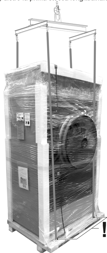
Esempio: Sollevamento gru con traversa
