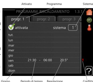
**Regolazione:** qui viene impostato l'offset di riscaldamento in relazione al menu 1.1 durante la programmazione. Se viene installato un sensore ambiente, la temperatura ambiente desiderata viene impostata in °C.
