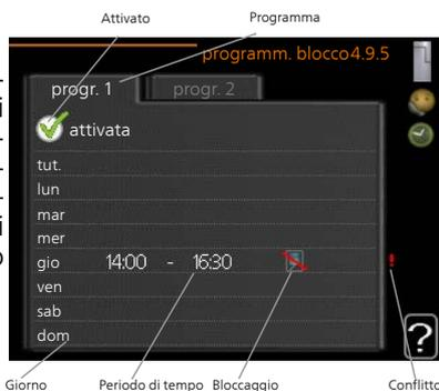
Quando la programmazione è attiva, nel menu principale verrà visualizzato il simbolo del bloccaggio effettivo sul simbolo della pompa di calore.
