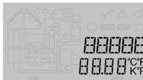
L'indicatore di canali è composto di due righe. La riga superiore è un campo alfanumerico a 16 segmenti nel quale vengono indicati principalmente i canali e le voci di menu. Nella riga inferiore a 16 segmenti vengono visualizzati i valori.
