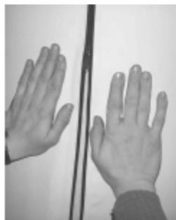
15. Posare il rivestimento in PVC intorno all'accumulatore e chiudere con cautela la chiusura a cerniera. Aiutarsi eventualmente battendo leggermente con il palmo della mano.
