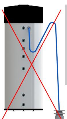
Il tubo per lo scarico della condensa deve essere correttamente inserito nello scarico e condotto nello scarico. Se il tubo di scarico viene instradato sopra lo scarico della condensa, la condensa può rifluire nel BWP. I danni causati da questo errore di montaggio sono esclusi dalla garanzia del produttore.
