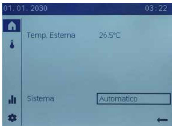
Utilizzare il commutatore impianto/zone "Off" quando si esce per più tempo dalla casa o dall'appartamento. L'edificio rimane protetto. Il consumo di energia viene ridotto al minimo.
