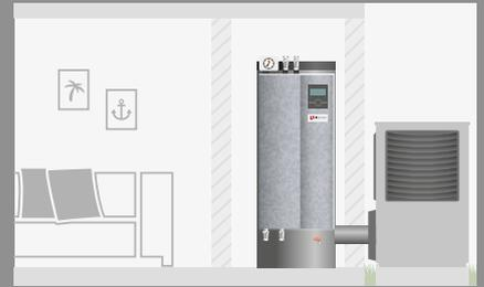
Mit Hydraulikstation mit integriertem Speicher ist eine Kühlung bis +18 °C Vorlauftemperatur möglich
