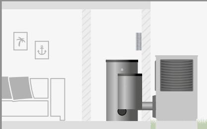
Mit Wandregler ist eine Kühlung bis +7 °C Vorlauftemperatur möglich (erfordert 4-Rohr Heiz-/Kühlsystem)
