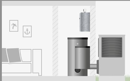
Mit Hydraulikmodul und Speicher ist eine Kühlung bis +18 °C Vorlauftemperatur möglich
