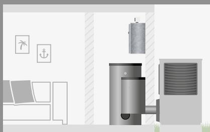
Con il modulo idraulico e il serbatoio d'accumulo è possibile il raffreddamento con temperatura di mandata fino a +18 °C
