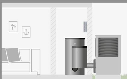
Con il regolatore a parete è possibile il raffreddamento con temperatura di mandata fino a +7 °C (richiede un sistema di riscaldamento/raffreddamento a 4 tubi)
