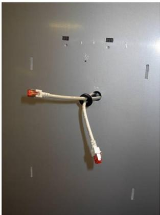
3. Passer le câble réseau au travers de la carrosserie et du passage de câble
