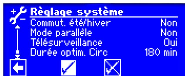
Aller sur Contrôle à distance (tourner le bouton pour se déplacer aller sur l'avant dernière ligne), choisir " Oui" et confirmer avec " √ "
