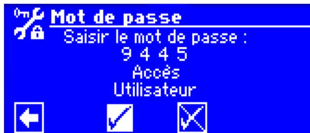
Presser le bouton sur le 1<sup>er</sup> chiffre, tourner le bouton jusqu'à ce que le "9" s'affiche, confirmer avec une pression sur le bouton. Procéder de la même façon avec les autres positions (4,4,5). Aller sur le "√" et presser 2 x le bouton.
