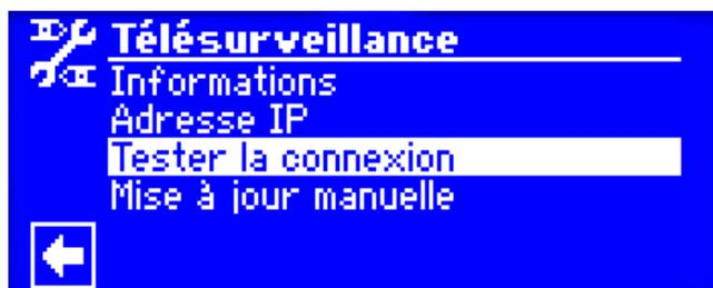
Retourner dans le menu Contrôle à distance choisir " Contrôle de la connexion"
