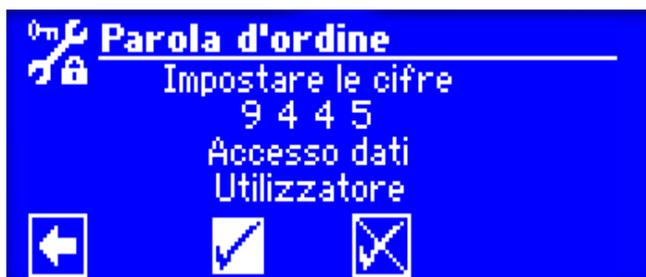
Impostare codice 9445 girando il pomello e premendo ogni volta. Selezionare il segno "visto" e premere 2 volte il pomello.
