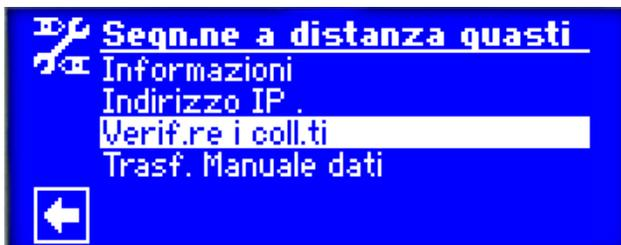
Tornare a "servizio remoto" e selezionare *prova collegamento* e premere pomello.
